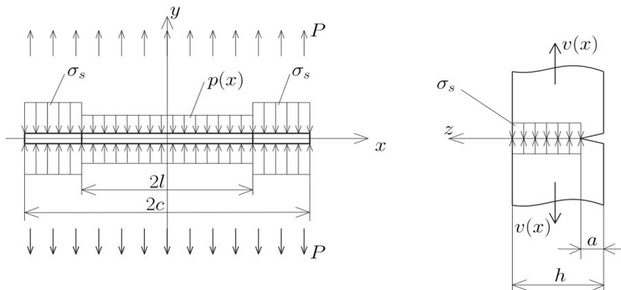
Рис. 1. Схема нагружения берегов царапины с постоянной глубиной
