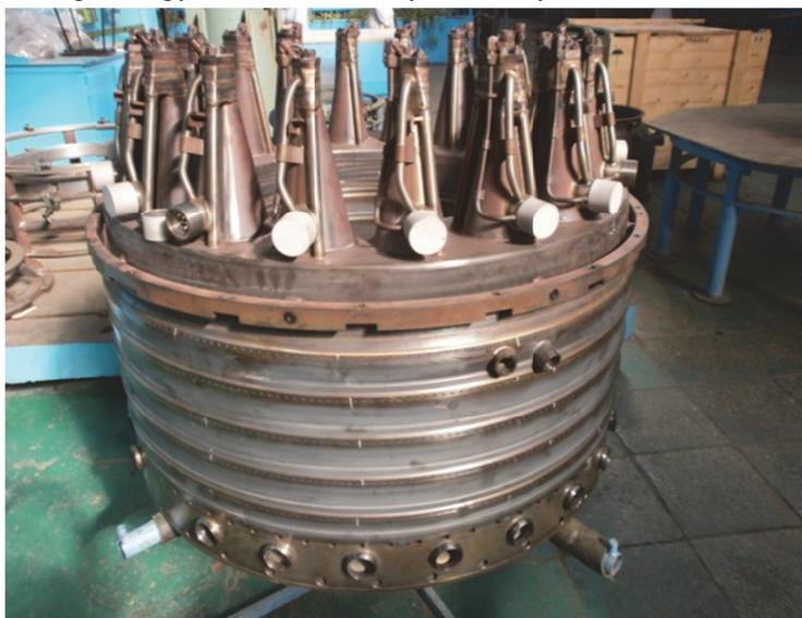
*Рис. 1. Камера сгорания ГТУ SGT-600*
