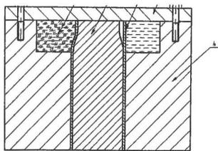
Рис. 4 – Штамп для обжима трубчатой заготовки с использованием энергии расширения воды при ее заморозке
