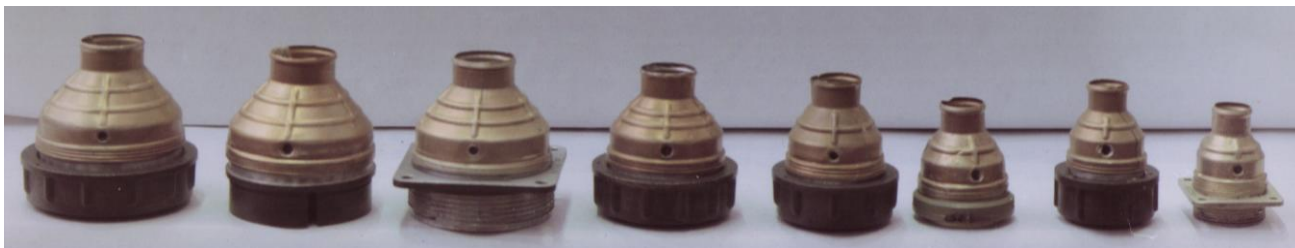
Рисунок 1. Облегченные корпуса разъемов БКС изготовленные импульсным магнитным полем.
