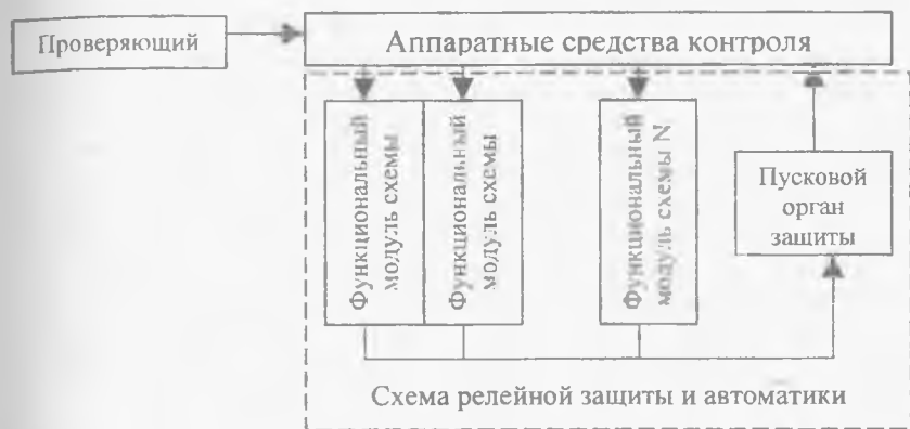
Рис. 2. Схема контроля правильности функционирования схем релейной защиты и автоматики.
