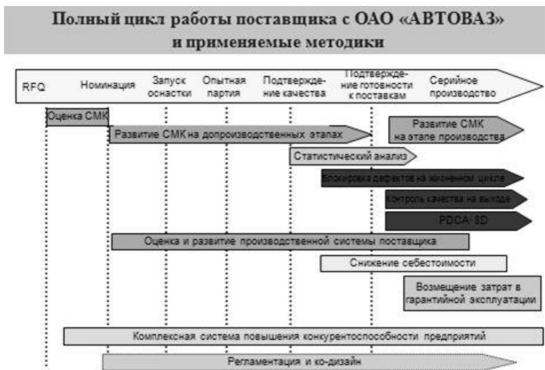
Рисунок 2. Пример системы взаимодействия с поставщиками в автопроме (RFQ - выставление требований поставщикам, SMK – система менеджмента качества, PDCA/SD – процесс непрерывных улучшений)
