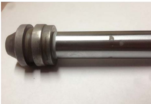
Рис. 1. «Поршень со штоком» из сплава ВТЗ-1 с дефектами хромового покрытия
