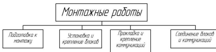
Рисунок 17.2 – Классификация монтажных работ по составу операций
