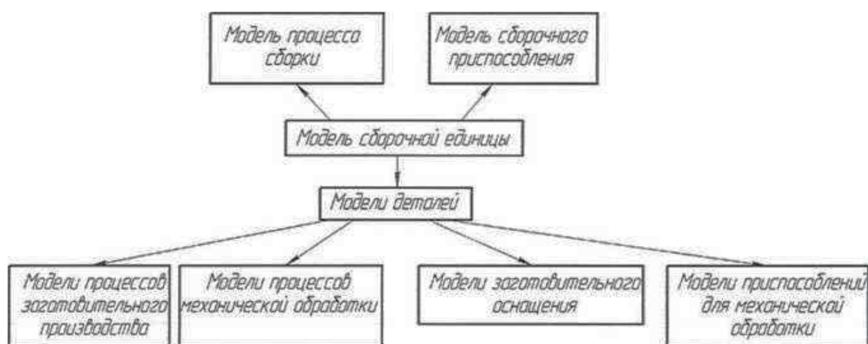
Рисунок 7.1 – Схема передачи информации при безплазовой увязке для сборочной единицы
