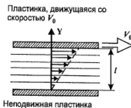
Рисунок 1.7 – Схема к объяснению понятия вязкости воздуха
