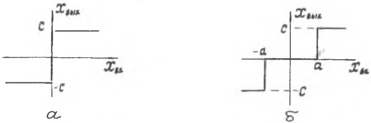
Рис.1.1. Релейные характеристики нелинейных звеньев
