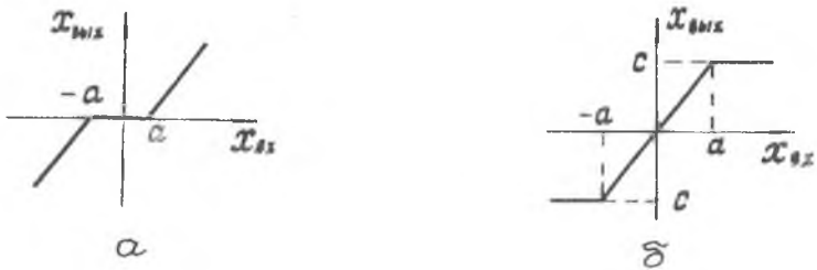
Рис.1.2. Кусочно-линейные характеристики нелинейных звеньев
