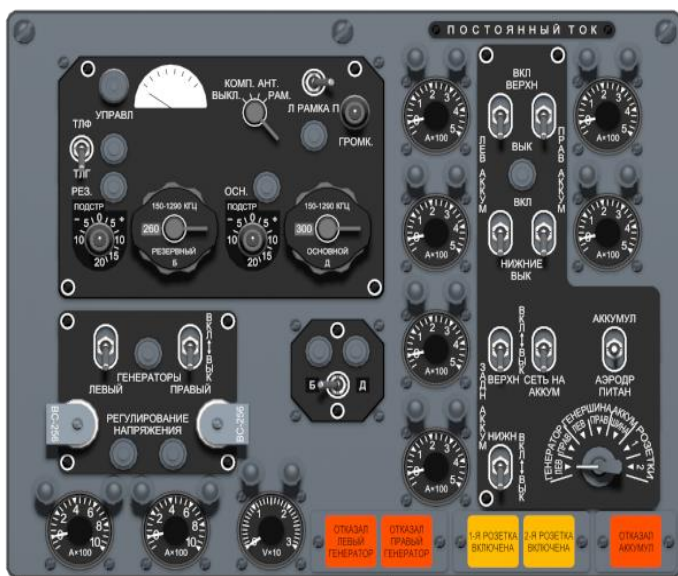
Рис. 3. Щиток энергетики постоянного тока
