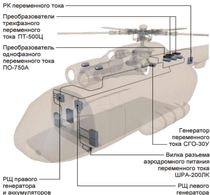
Рис. 7. Источники переменного тока и их РЩ
