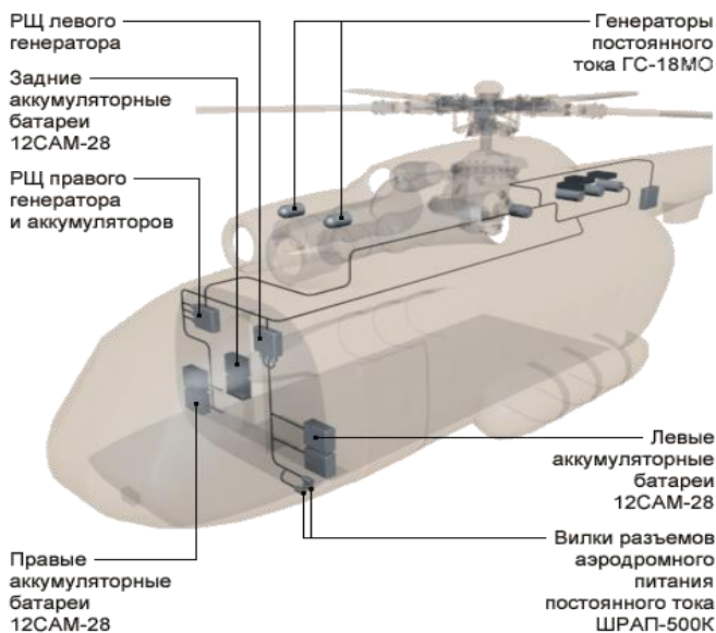
Рис. 2. Источники постоянного тока и их РЩ
