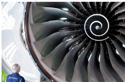
Диаметр вентилятора двигателя Rolls-Royce Trent XWB составляет 3 метра
