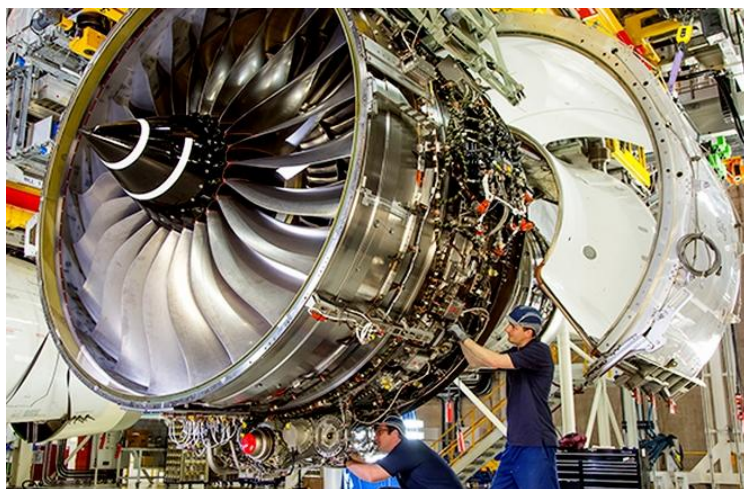
Тяга двигателя Trent XWB-97 составляет почти 44 тонн (Rolls-Royce)
