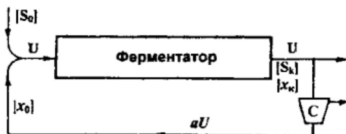
**Рис. 3.8.** *Схема работы тубулярного ферментатора с частичным возвратом биомассы. C – сепаратор (центрифуга или отстойник)*
