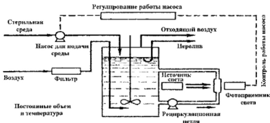
Рис. 6.7. Блок-схема турбидостата [2 осн.]
