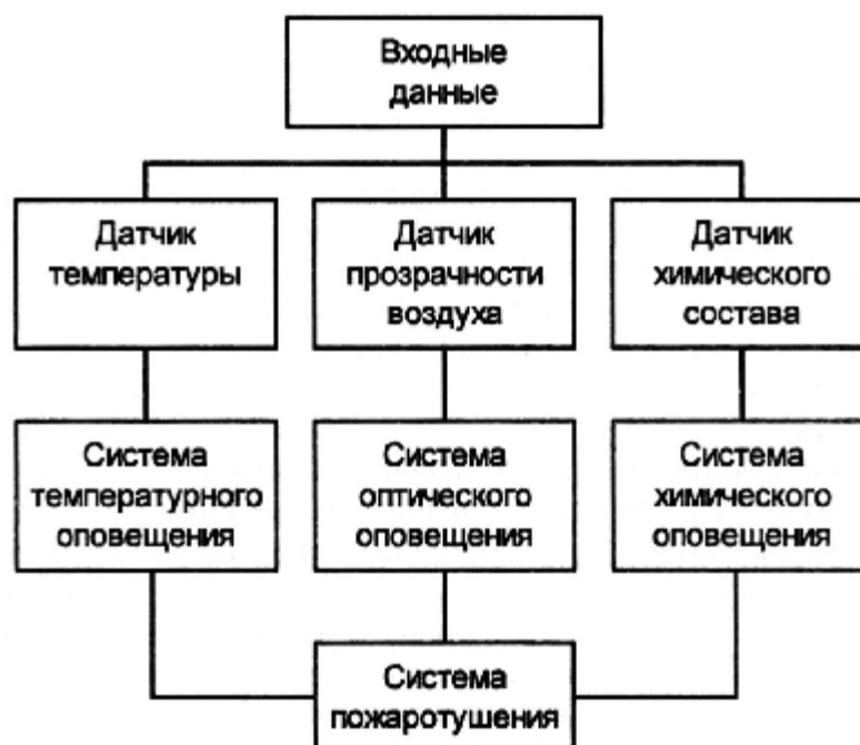
Рис. 1.17. Пример карты потоков для системы пожарозащиты
