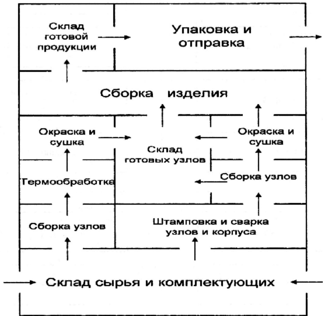
Рис. 1.14. Пример организации сборочного производства
