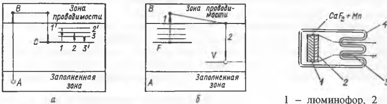
Рисунок 61. Зонные диаграммы, поясняющие механизм возникновения РФЛ (а) и РТЛ (б)
