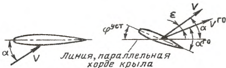
Рис.4. Определение угла атаки горизонтального оперения
