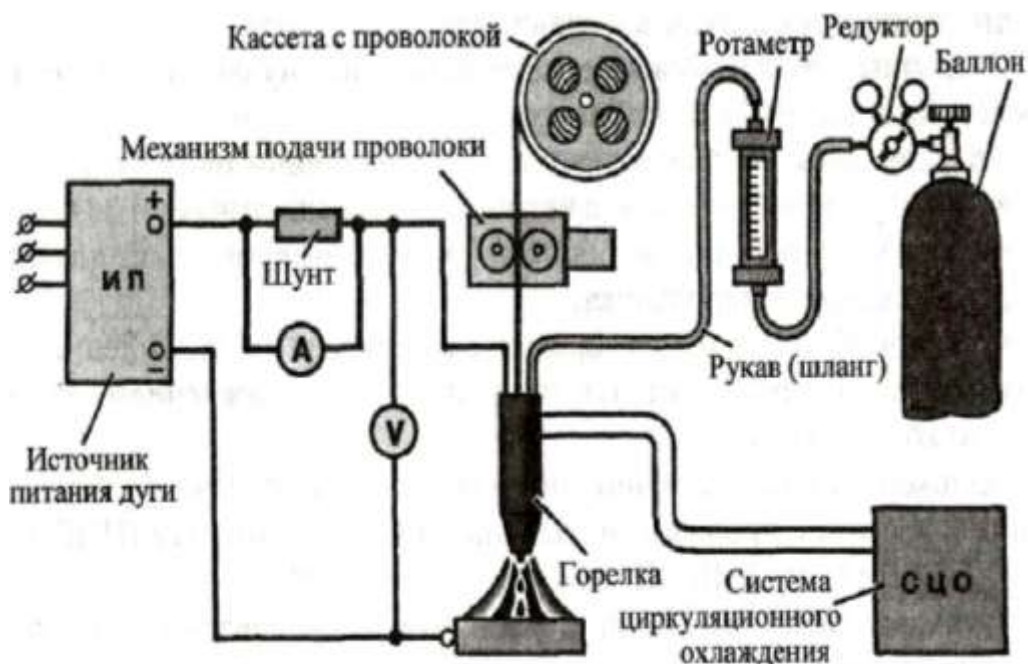
Рис. 3.7. Схема поста для сварки плавящим электродом в углекислом газе
