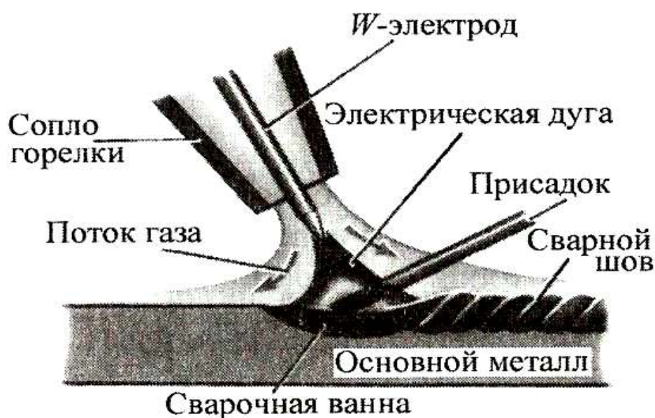
Рис. 2.1. Схема процесса ручной дуговой сварки в среде инертных газов
