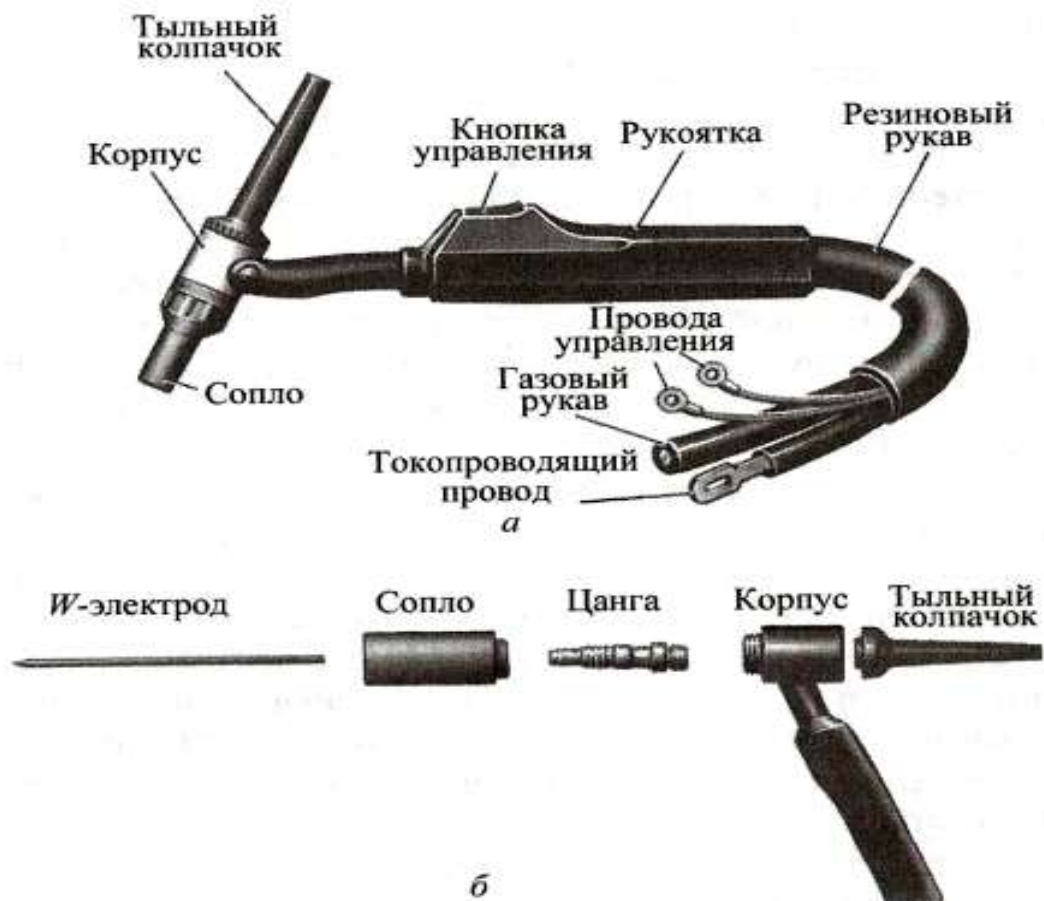
Рис. 2.10. Горелка для ручной сварки
