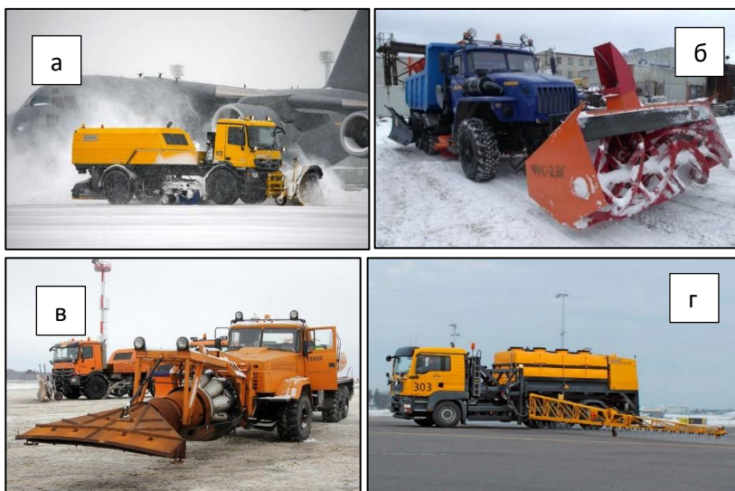
Рис. 7.1. Машины для очистки аэродрома от снега и льда: а – плужно-щеточная машина; б – шнекороторная машина; в – газоструйная машина; г – машина для нанесения химических реагентов
