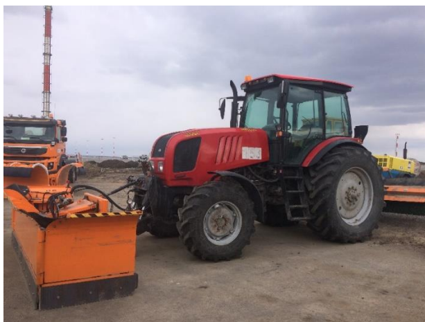
Рис. 7.2. Плужно-щеточное оборудование на тракторном шасси
