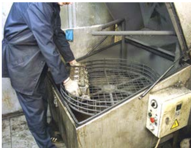
Рис. 7.1. Установка головки блока цилиндров в автоматическую моечную машину (фирма «Мотор-Технология», г. Москва). Мойка осуществляется моющим составом при 80°С
