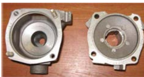
Рис. 3.3.14. Детали конструкции жидкостного насоса: 1 - крышка, в которую устанавливается крыльчатка; 2 - корпус
