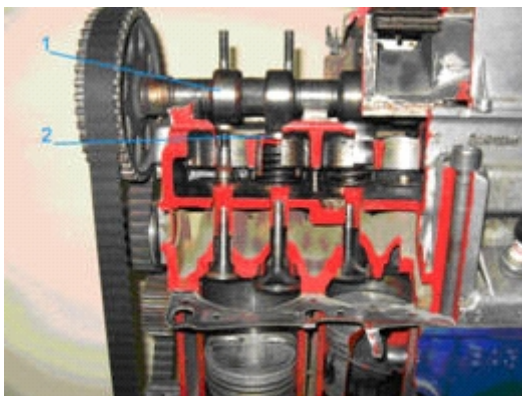
Рис. 3.2.3. Внешний вид и устройство газораспределительного механизма двигателя ВАЗ-21083: 1 - кулачки распределительного вала, 2 - регулировочные шайбы
