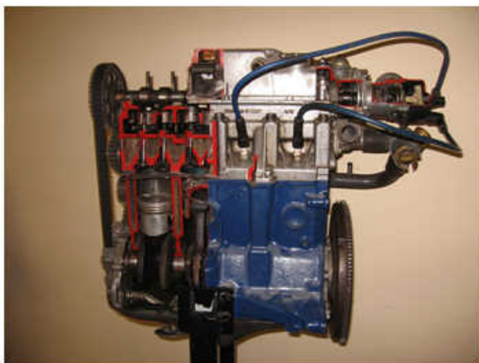
Рис. 1.1. ДВС легкового автомобиля с однорядным вертикальным расположением цилиндров
