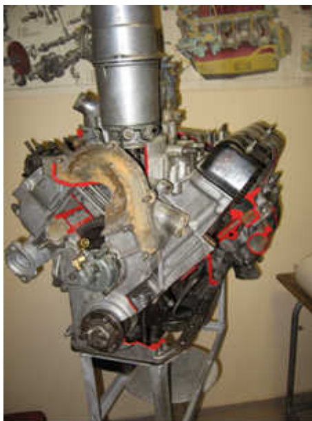
Рис. 1.2. ДВС грузового автомобиля с V-образным расположением цилиндров
