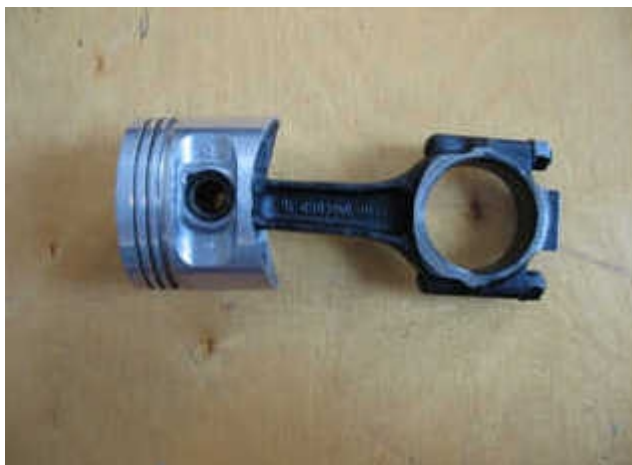
Рис. 3.1.6. Поршень двигателя VAZ-2112 в сборе с шатуном (хорошо виден палец)
