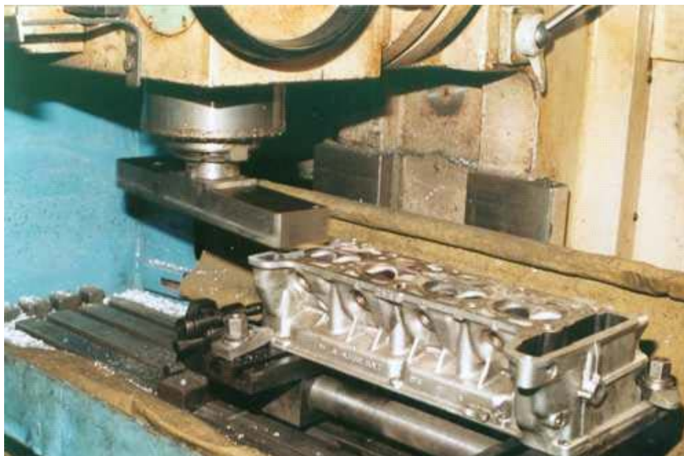
Рис. 7.10. Фрезерование плоскости головки блока (фирма "АБ - Инжиниринг", г. Москва)
