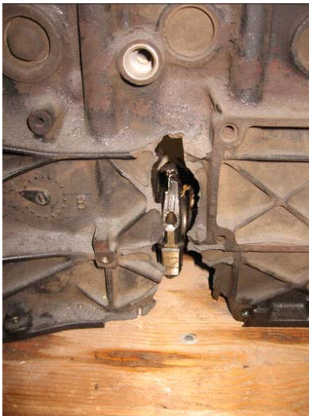
Рис. 5.11. Обрыв шатуна и его последствия для блока цилиндров
