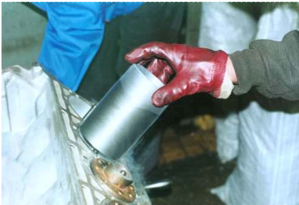
Рис. 7.2. Установка гильз в блок цилиндров после их охлаждения в жидком азоте
