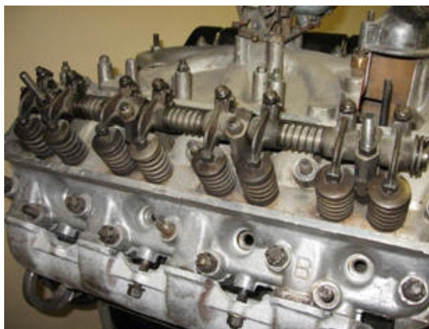
Рис. 3.2.8. Ось коромысел, коромысла и пружины клапанов
