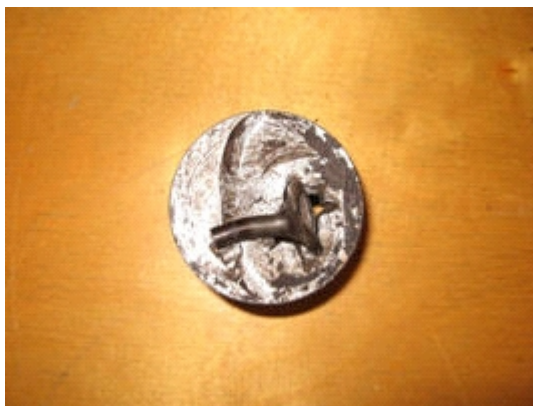
Рис. 3.2.11. Последствия обрыва ремня ГРМ (разрушение поршня и обрыв клапана)
