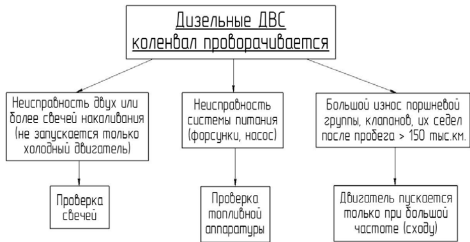
Рис. 6.7. Основные неисправности двигателей и способы их обнаружения, при условии, что проворачивание коленчатого вала возможно
