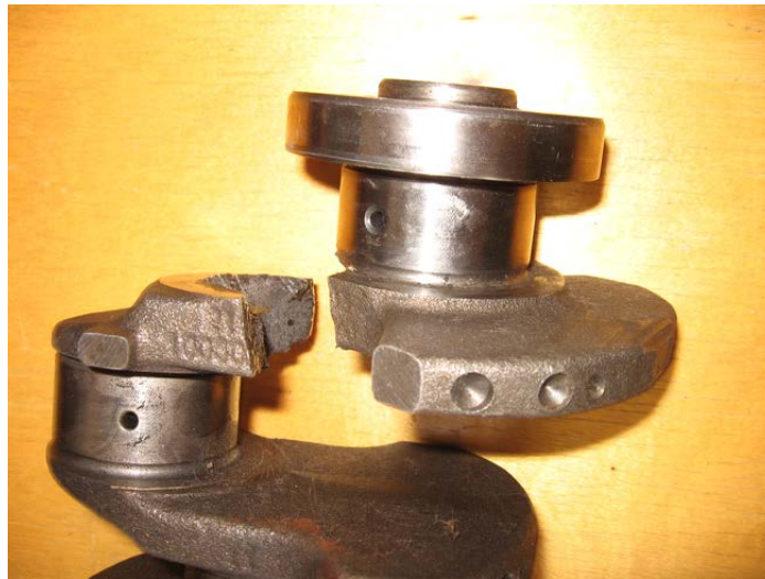
Рис. 5.15. Разрушение коленчатого вала форсированного двигателя при резком открытии дроссельной заслонки
