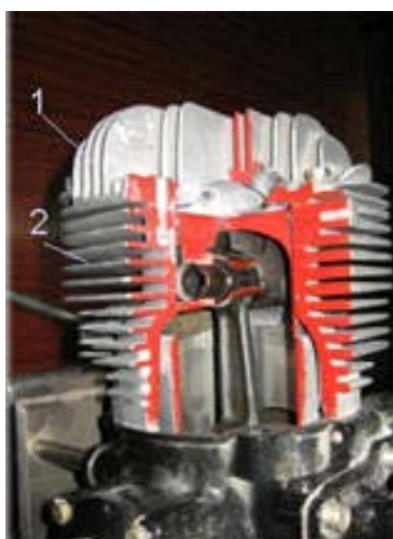
Рис. 3.3.28. Ребрение цилиндра и головки двигателя с воздушным охлаждением: 1 - ребрение головки; 2 - ребрение цилиндра
