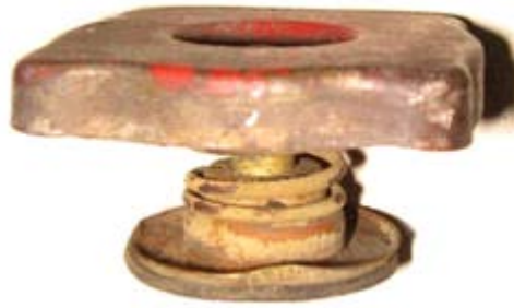
Рис. 3.3.12. Пробка к заливной горловине радиатора с системой клапанов дренажа: 1 - корпус; 2 - вентиляционный клапан; 3 - выпускной клапан
