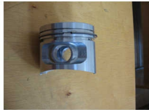
Рис. 3.1.3. Поршень двигателя VAZ-2105 (вид сбоку) - хорошо видны приливы для крепления пальца и канавки для колец
