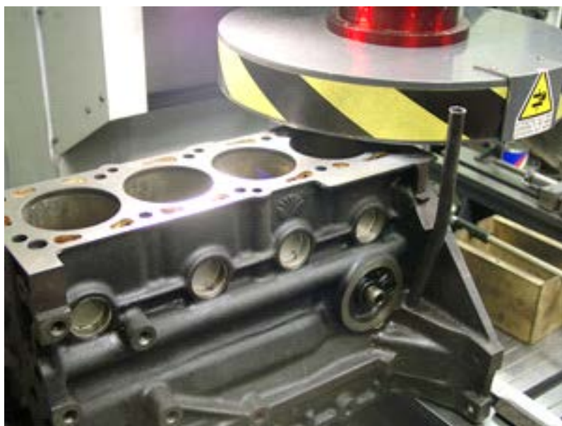
Рис. 7.9. Фрезерование плоскости блока цилиндров в фирме «Мотор - Технология» (г. Москва)
