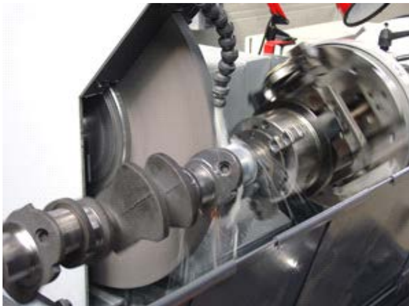
Рис. 7.7. Шлифовка шеек коленчатого вала в фирме «Мотор - Технология» (г. Москва)
