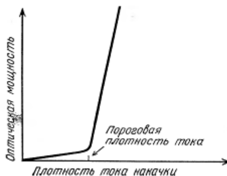
Рисунок 14 - Зависимость светового излучения на выходе лазерного диода от тока накачки на входе.
