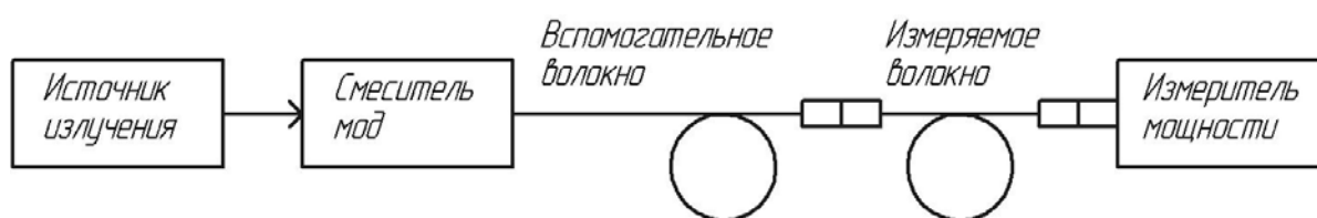
Рисунок 3 – Схема установки для измерения затухания сигнала методом вносимых потерь
