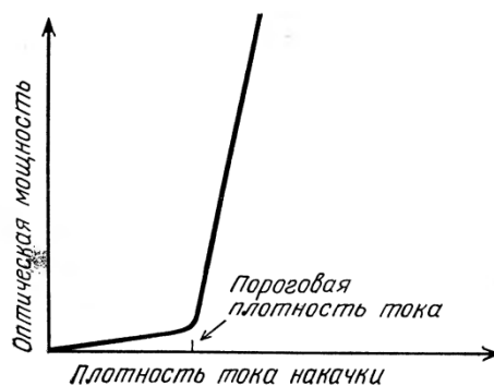
Рисунок 7 - Зависимость светового излучения на выходе лазерного диода от тока накачки на входе.
