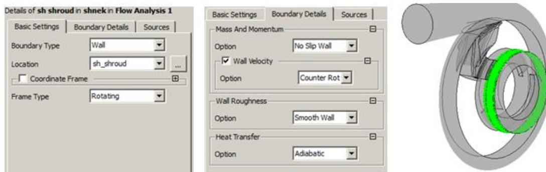
Рис. 2.46. Меню граничного условия непроницаемой стенки на поверхностях периферийного обвода шнека
