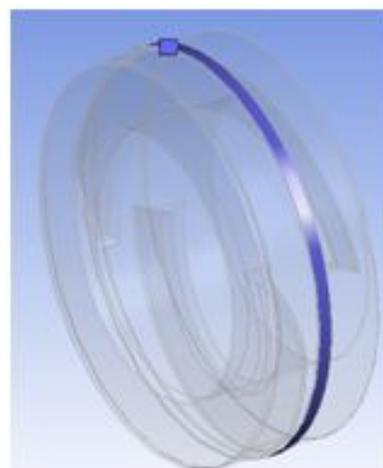
*Рис. 2.29. Настройки меню указания размера элемента на грани интерфейса объемов шнека и надроторной полости*
