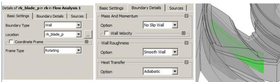
Рис. 2.53. Меню граничного условия непроницаемой стенки на поверхностях лопатки крыльчатки
