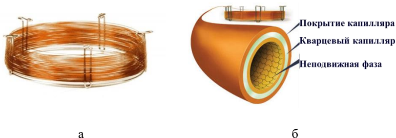
Рис. 18. Внешний вид (а) и строение (б) капиллярной колонки
