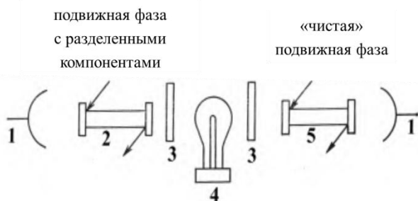
Рис. 27. Схема фотометра с фиксированной длиной волны: 1 – фотоприемник (фотоумножитель); 2 – рабочая микрокювета; 3 – оптический фильтр; 4 – ртутная лампа; 5 – сравнительная микрокювета
