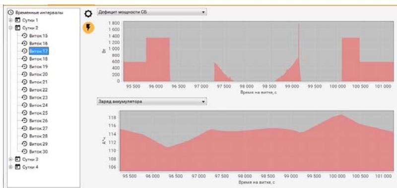
Рис. 4.45 – Графики дефицита мощности и заряда аккумулятора за виток
