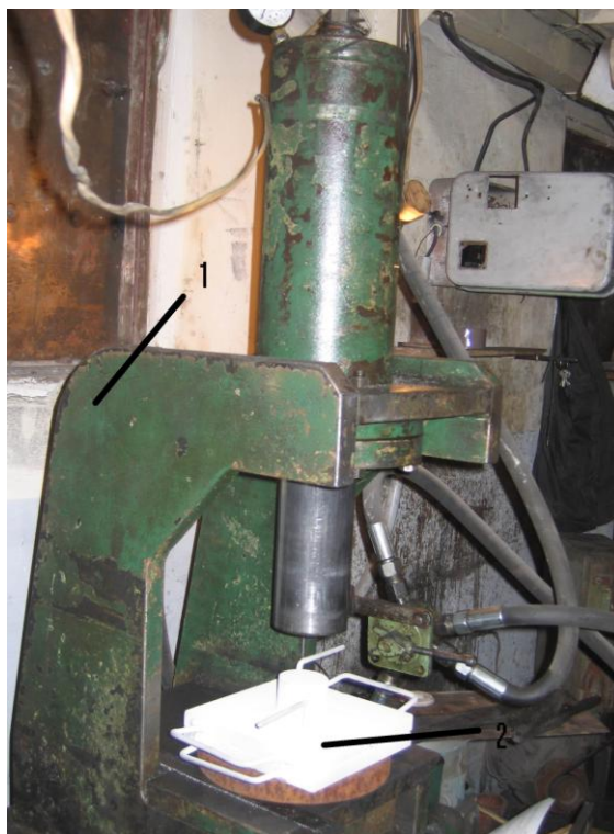
1 – гидравлический пресс; 2 – штамповая оснастка
