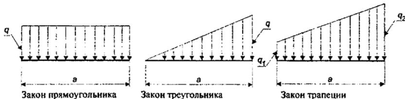
Рис. 9. - Законы распределения нагрузки
