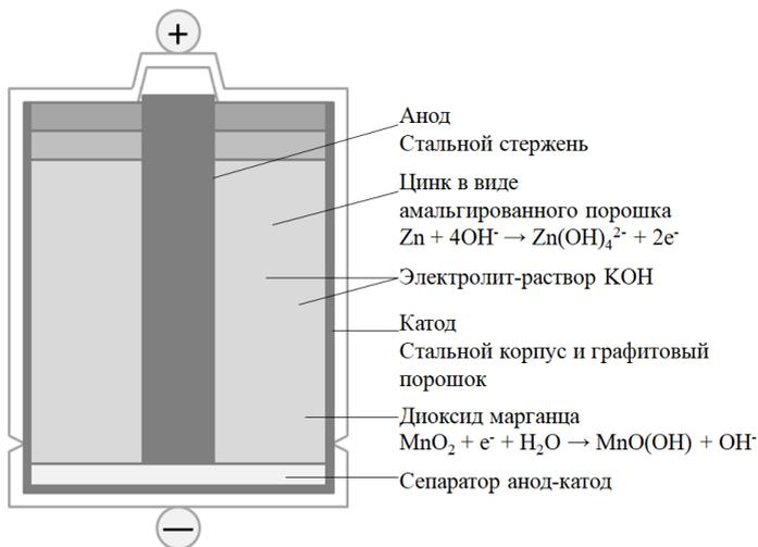
Рис. 21. Схема цилиндрической «щелочно-марганцевой» батареи
