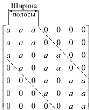
Рис. 1.13. Матрица коэффициентов в системе алгебраических уравнений
