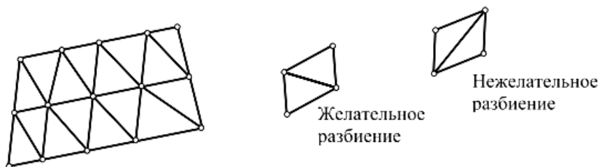
Рис. 1.11. Разбиение зоны четырехугольными элементами
