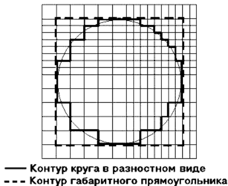
Рис. 1.22. Пример двумерной сетки МКР и ошибки при определении периметра, которая не зависит от густоты разностной сетки
