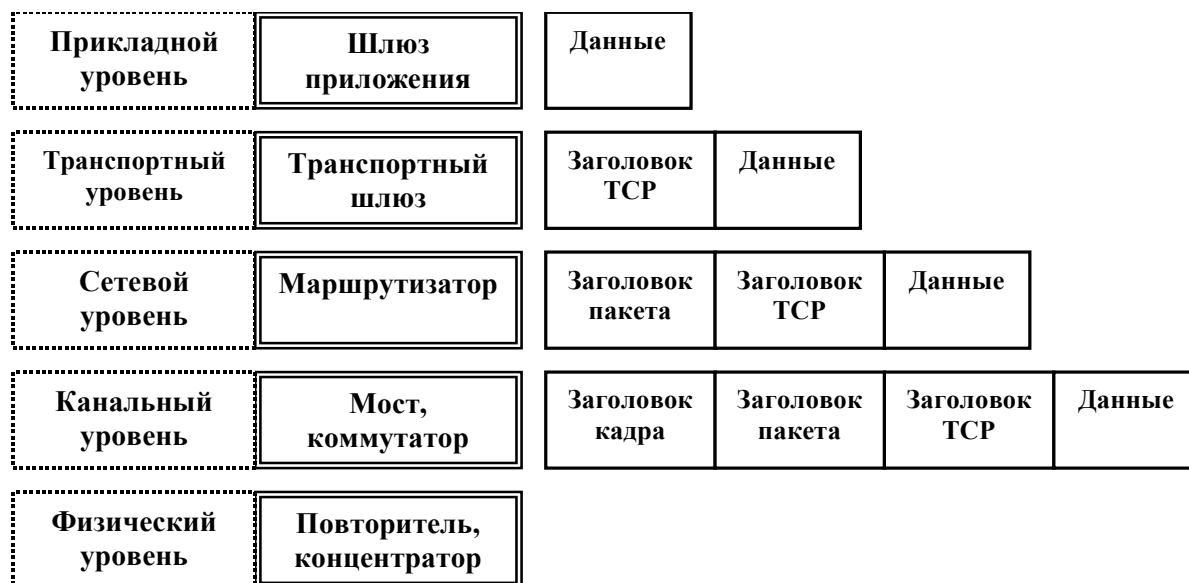
Рис. 9.6. Соответствие коммуникационных устройств уровням модели OSI
