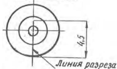
Р и с. 15П. Переход с полосковой линии на коаксиальный кабель:
