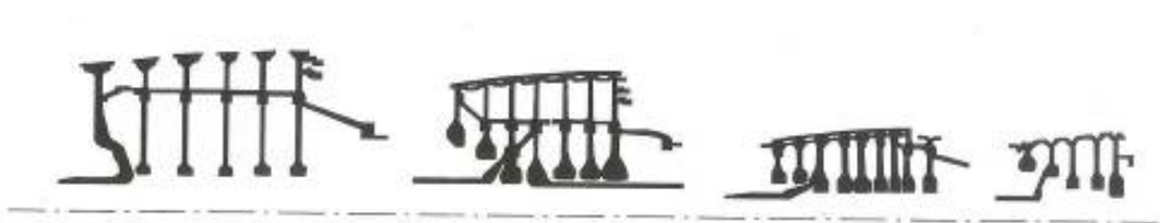
Рис. 49. Сравнение конструкции роторов КВД двигателей различных поколений
