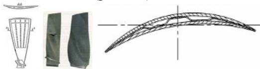
Рис. 31. Конструкции вентиляторных лопаток: полая лопатка двигателя E 3 , лопатка с антивибрационной полкой, широкохордная лопатка, лопатка с использованием сверхпластичной формовки и диффузионной сварки
