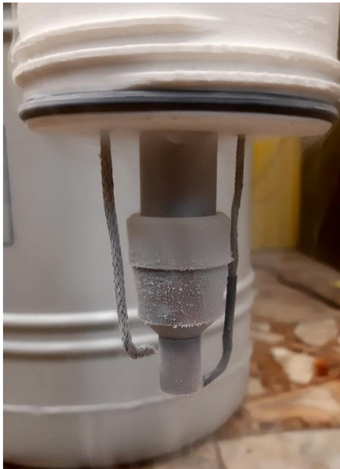
Рисунок 4.3.2 – Медный наконечник крышки криостата после проведения эксперимента
