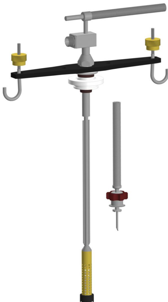
Рисунок А.1 – Внешний вид криогенной испарительной установки
