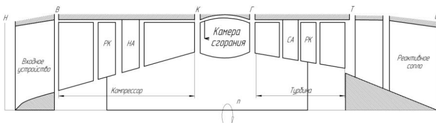
Рис.1.2. Схема проточной части одновального турбореактивного двигателя
