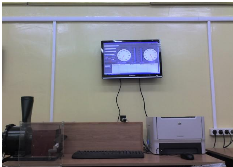
Рис. 5.8. Лабораторная установка для изучения рабочего процесса и снятия характеристик кольцевого лопаточного венца ЦСМТ
