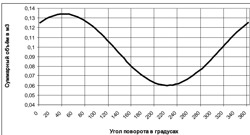
Рисунок 7.8 – Зависимость суммарного объема от угла поворота
