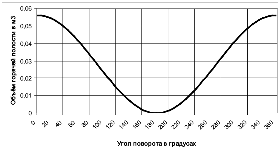
Рисунок 7.6 – Зависимость объёма горячей полости от угла поворота
