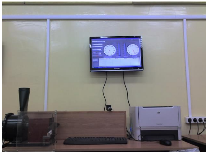
Рис. 5.8. Лабораторная установка для изучения рабочего процесса и снятия характеристик кольцевого лопаточного венца ЦСМТ
