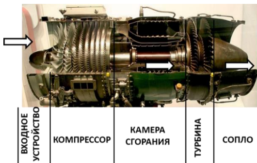
Рис. 1.2. Схема проточной части одновального турбореактивного двигателя
