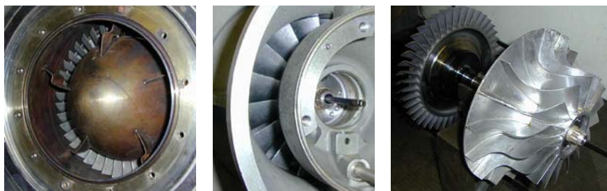
Рис. 7.26. Элементы конструкции ТРД TRS 18
