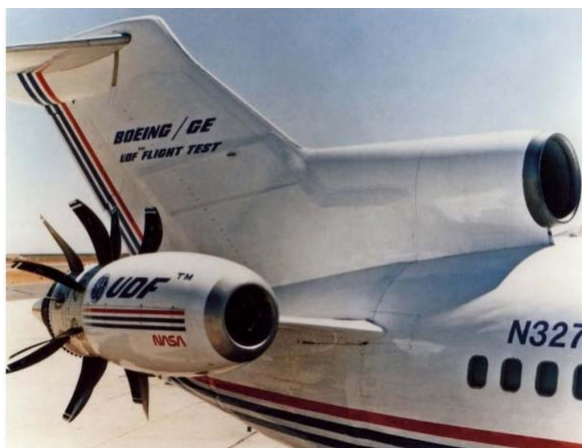
Рис. 5.7. Летающая лаборатория для испытаний ТВД толкающего типа GE36
