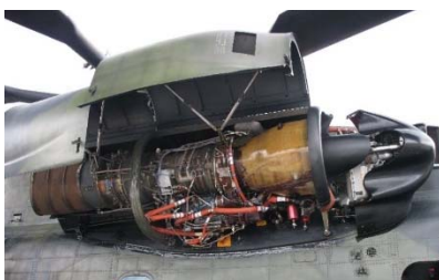
Рис. 8.3. General Electric T64 и вертолет Lockheed Ан-56 Cheyenne
