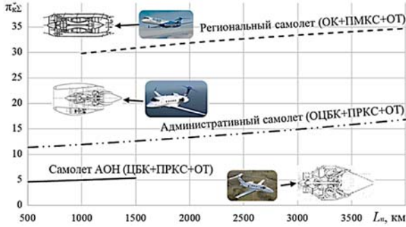
Рис. 6.29. Зависимость рациональной степени повышения давления от дальности полета для разных типов самолетов
