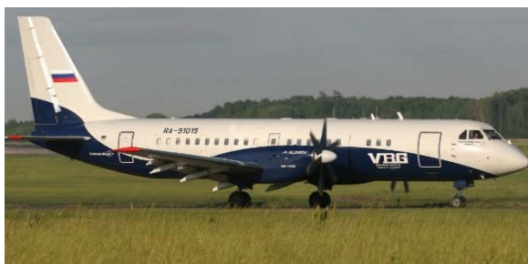
Рис. 8.26. ТВ7-117С и самолет Ил-114
