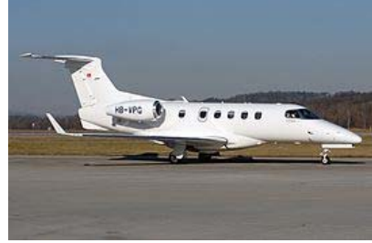
Рис. 1.14. Самолет Эмбраер Феном 100 [216]: L_n = 2148 км; M_0 = 7950 кг; n_{\text{пас}} = 6-7 ; V_{\text{max}} = 875 км/ч; 2 × ТРДД Pratt & Whitney PW 535-E ( P = 24 кН)
