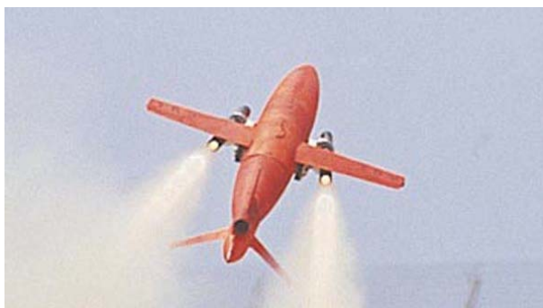
Рис. 1.27. Многоцелевой беспилотник Checker взлетает со стартовыми ускорителями
