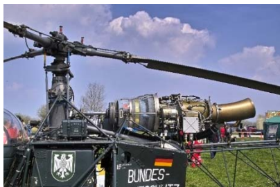
Рис. 8.5. Turbomeca Astazou и вертолет Аérospatiale Alouette II
