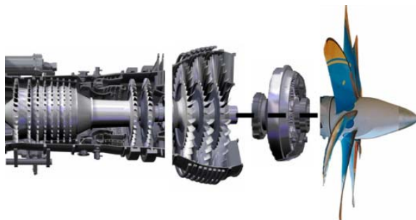
Рис. 5.13. Схема с редуктором, расположенным сзади по движению потока газа и приводимым от свободной турбины
