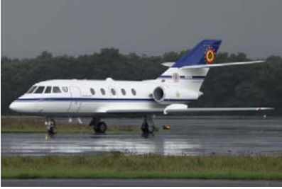
Рис. 1.13. Самолет Фалькон 20 [215]: L_n = 3350 км; M_0 = 7\,530 кг; n_{\text{пас}} = 8-14 ; V_{\text{max}} = 862 км/ч; General Electric CF700-2D-2 ( P = 20 кН)
