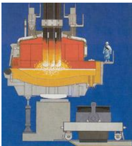
Рис.1.49 Схема дуговой плавильной печи
