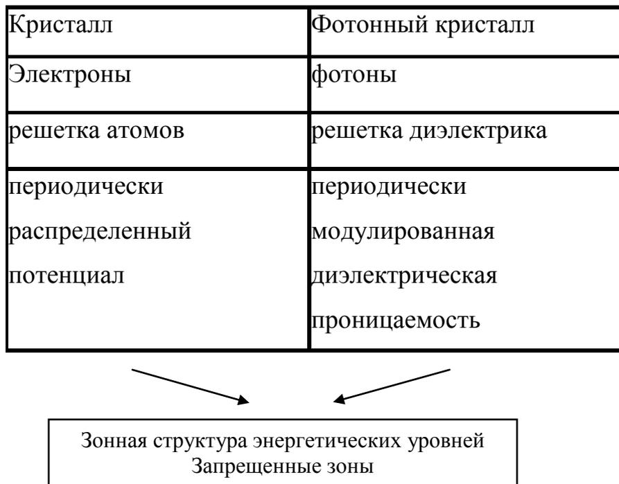
Рис. 1.1 Сравнение обычного (электронного) кристалла с фотонным кристаллом
