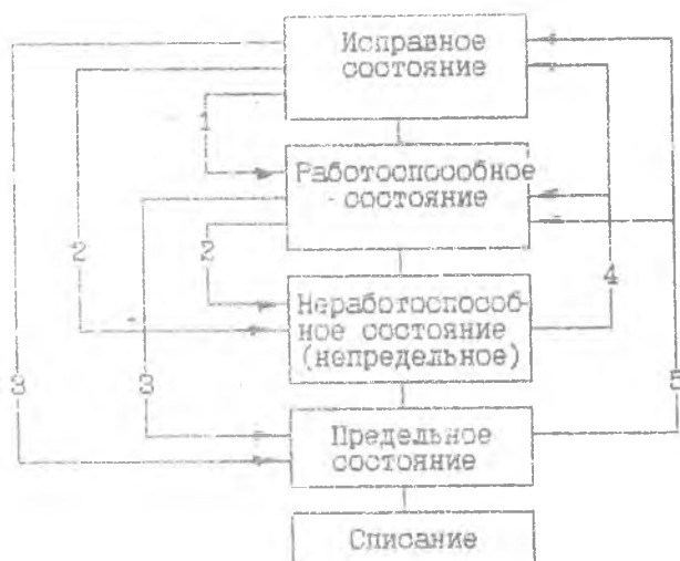
Рис. 3.1. Схема основных состояний и событий: 1 — повреждение; 2 — отказ; 3 — переход объекта в предельное состояние; 4 — восстановление; 5 — ремонт
