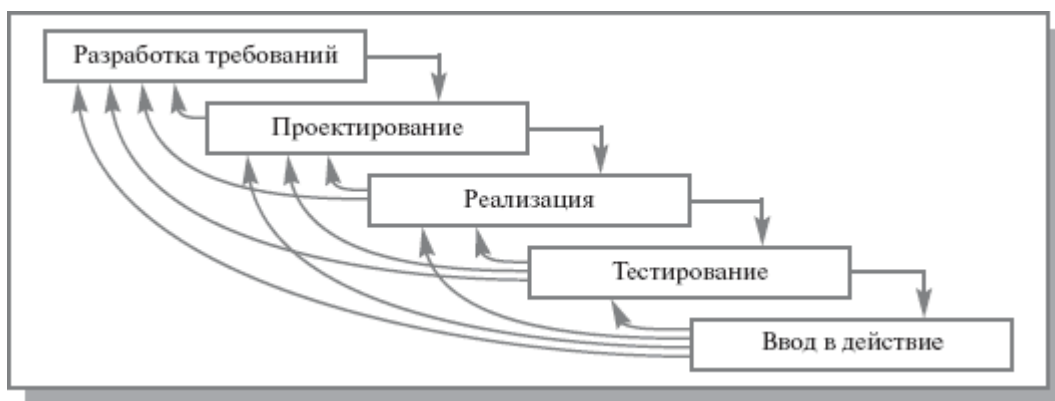
Рисунок 2. Реальный процесс разработки по каскадной схеме
