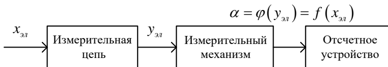
Рис. 2.9. Обобщенная структурная схема электромеханических приборов
