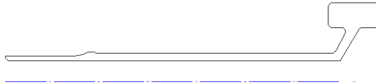
Рисунок 71 – Геометрия плоского контура заготовки рессоры, полученная по параметрической модели
