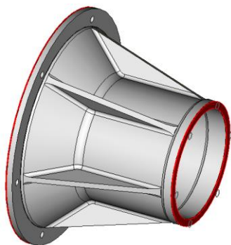
Рисунок 31 – Объёмная модель корпуса выходного вала с прокладками
