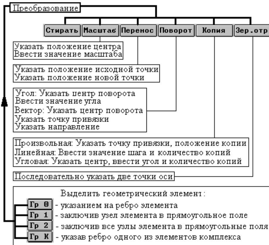
Рисунок 6 - Алгоритмы аффинных преобразований на плоскости
