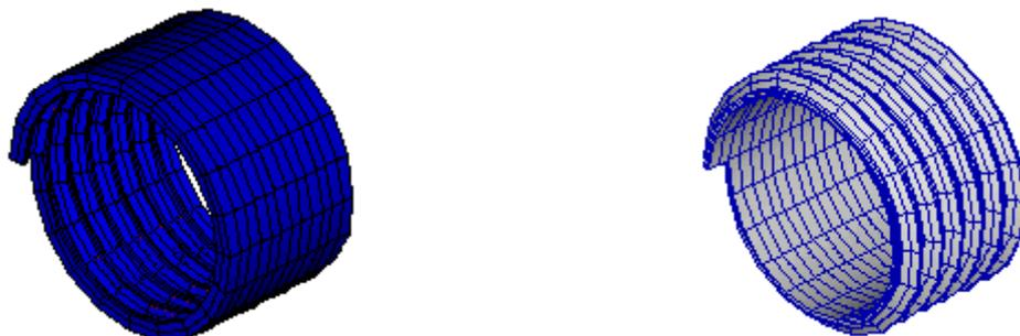
Рисунок 11 - 3D модели внутренней и наружной резьбы.
