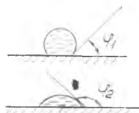
Рис. 7. Изменение краевого угла \varphi капли воды в зависимости от чистоты поверхности обшивки ( \varphi_1 — «чистая обшивка», \varphi_2 — «грязная» обшивка)
