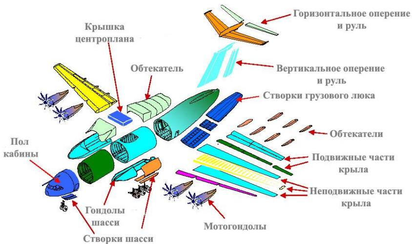
Рис. 2. Схема членения самолета Airbus A400
