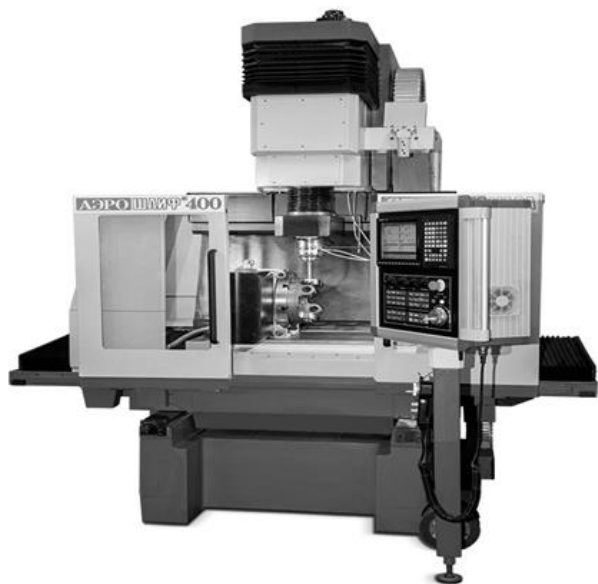
Рис. 1.17. Вертикальный координатно-шлифовальный станок особой точности мод. Аэрошлиф 400 (производитель ЗАО «Стан-Самара» г. Самара)
