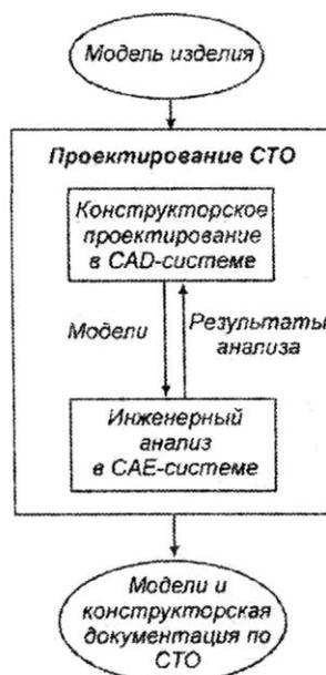
Рис. 7. Роль САЕ-систем в проектировании средств технологического оснащения (СТО)
