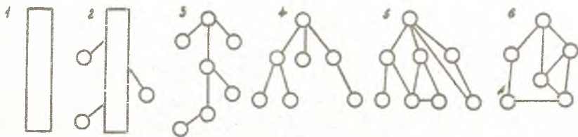
Р и с. 15. Структуры программ: 1 — монолитная; 2 — монолитно-модульная; 3 — последовательно-модульная; 4 — иерархическая; 5 — иерархически-хаотическая; 6 — модульно-хаотическая
