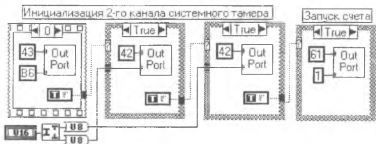
Рис. 6.7. СубВП инициализации второго таймерного канала
