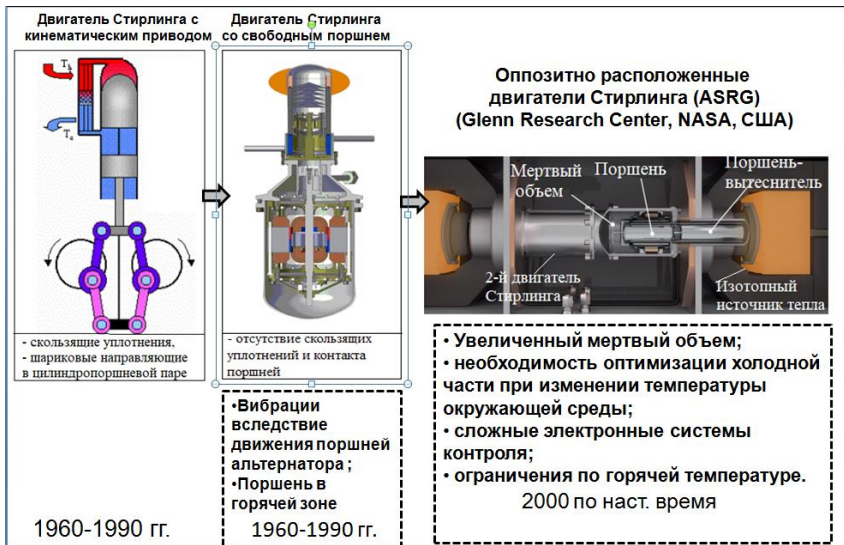
Рис. 2. Конструкция свободнопоршневого двигателя Стирлинга
