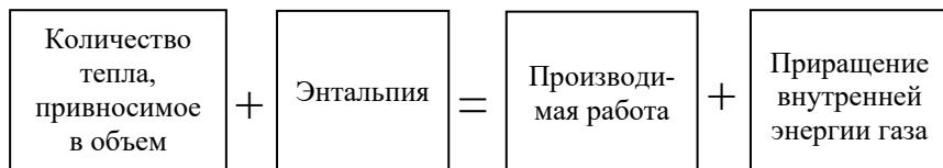
Рис. 16. Энергетический баланс элементарного объема
