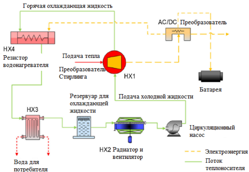
Рис. 3. Схема электрогенерирующей установки на основе свободнопоршневого двигателя Стирлинга, использующего теплоту, выделяемую при горении биотоплива
