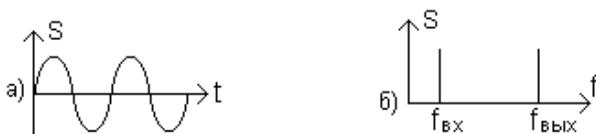
Рис.2.69 Выходной сигнал ЛБВ (а) и его спектр (б) при изменении фазы сигнала кратном  $2\pi$ .
